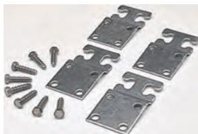
**Описание:** Монтажные скобы для настенной фиксации шкафов UCP. Создают зазор между стеной и шкафом в 20 мм.
