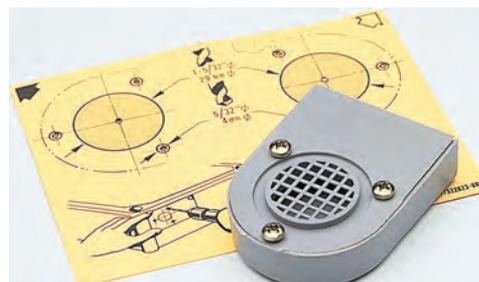
**Описание:** Два воздуховода на шкаф обеспечивают эффективную циркуляцию воздуха и предотвращают образование конденсата. Предпочтительно устанавливать по одному воздуховоду в верхней и нижней частях шкафа. Степень защиты: IP 44.
